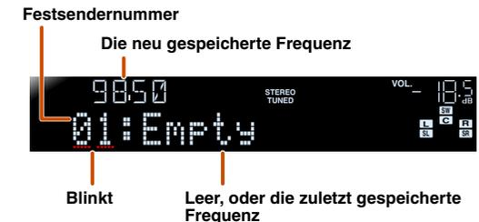
Drücken Sie **5**PRESET  $\wedge / \vee$ , um die Festsendernummer zu wählen, unter der Sender gespeichert werden soll, und drücken Sie dann **5**MEMORY, um den Speichervorgang durchzuführen.
