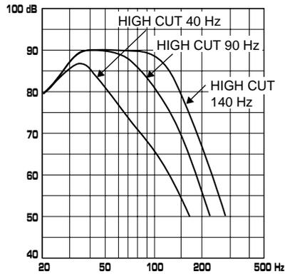
Les chiffres ci-dessous montrent le réglage optimal de chaque commande et les caractéristiques des fréquences lorsque ce subwoofer est associé à des enceintes principales classiques.
