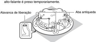
2 Ao levantar ligeiramente o alto-falante, gire a chave de fenda no sentido horário para apertar o parafuso de fixação. A primeira rotação do parafuso de fixação abre o fixador. Rotações adicionais movem o fixador para baixo no canal para puxar o alto-falante para cima no teto.
