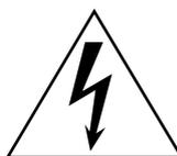
Il simbolo del fulmine con la freccia all'interno di un triangolo equilatero serve a segnalare all'utente la presenza, all'interno dell'apparecchio, di "corrente pericolosa", che può essere di intensità sufficiente a costituire un rischio di scossa elettrica.
