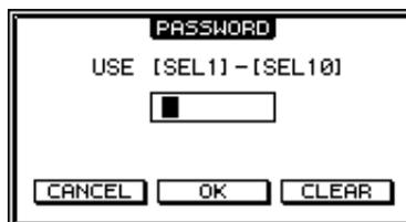
Inserite una password di quattro lettere usando i pulsanti [SEL] del canale 1–10 (il pulsante [SEL] del canale 10 inserisce “0”). (I caratteri della password sono visualizzati come asterischi.) Spostate il cursore sul pulsante OK, quindi premete [ENTER] per abilitare la funzione Operation Lock. La password di default della fabbrica è 1234.
