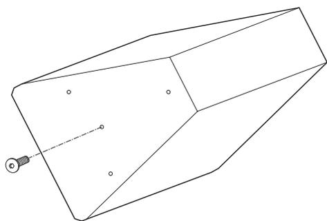
Se si utilizza il modello di altoparlante IF2112/AS(W), installare la staffa di fissaggio sull'altoparlante utilizzando le viti M10.
