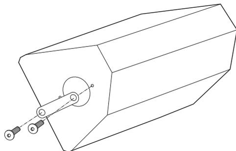
2. Posizionare la staffa a U sulla cassa dell'altoparlante e verificare che la staffa ordinata sia corretta. Inserire momentaneamente le guarnizioni di isolamento acustico tra i bracci della staffa e l'altoparlante. Rimuovere la staffa dall'altoparlante.
