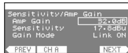
3. Utilizzare l'encoder A per spostare il cursore su Amp Gain o Sensitivity e l'encoder B per modificare il valore del parametro.
