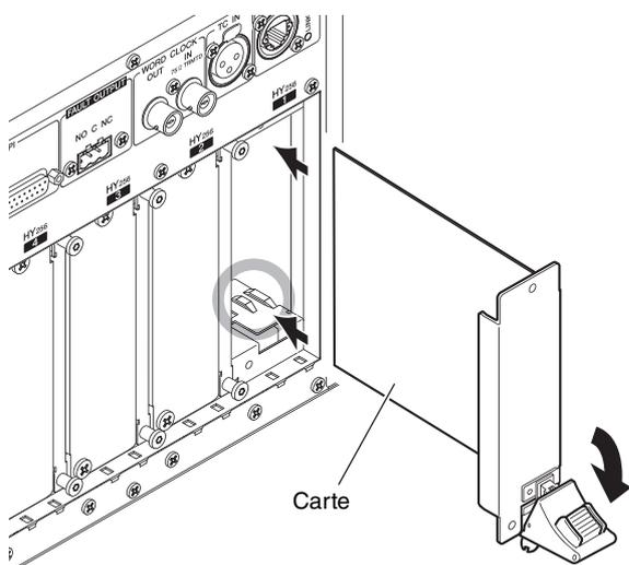
Enfoncez la carte dans le logement jusqu'à ce que le connecteur situé à l'extrémité de la carte soit correctement inséré dans celui du logement.
