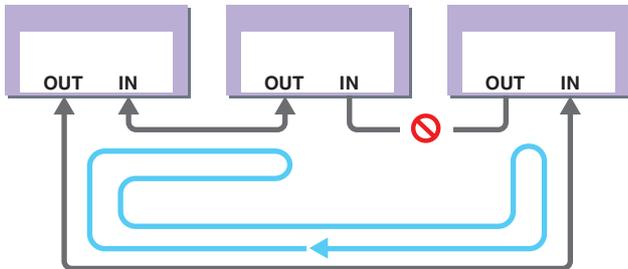
Même si un câble est sérieusement endommagé, le signal sera automatiquement réacheminé et la communication se poursuivra sans interruption.
