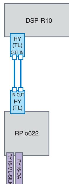
Utilisez des câbles à fibres optiques pour relier les connecteurs IN/OUT de la section TWINLANE sur la carte HY installée sur le moteur DSP aux connecteurs IN/OUT de la section TWINLANE sur la carte HY insérée dans le rack d'E/S.
