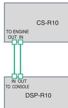
Utilisez des câbles Ethernet pour relier les connecteurs OUT/IN de la section TO ENGINE sur la surface de contrôle aux connecteurs OUT/IN de la section TO CONSOLE sur le moteur DSP.
