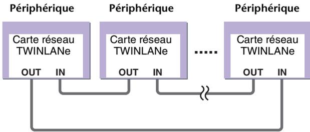
Un réseau TWINLANe utilise une topologie en anneau qui assure la redondance en cas de rupture de câble. Si un câble du réseau est endommagé pour une quelconque raison, le signal sera automatiquement réacheminé et les données audio continueront d'être transmises sans interruption. De ce fait, même lorsqu'un périphérique subit des dysfonctionnements au sein du réseau, le reste des dispositifs en état de fonctionnement sont en mesure de continuer à assurer la communication.
