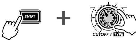
Bei gedrückter [SHIFT]-Taste wird der [CUTOFF]-Regler zum Auswahlschalter für den VCF Type. (Aus diesem Grund steht unter dem Regler neben „CUTOFF“ auch „TYPE“.)
