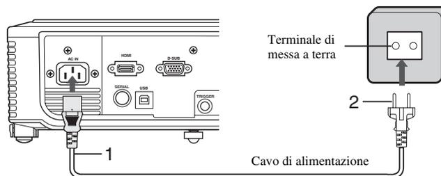
1. Collegare il cavo di alimentazione in dotazione al terminale AC IN di questo proiettore.
