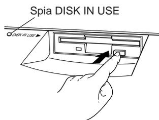
Non tentate di togliere il disco o di escludere l'alimentazione durante la registrazione, la lettura e l'esecuzione del playback. Potreste infatti danneggiare il disco o anche il disk drive.
