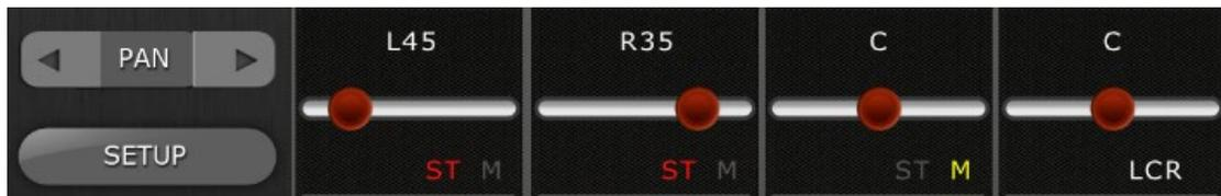
Durch Text wird angezeigt, ob die einzelnen Kanäle den ST-, Mono- oder LCR-Bussen zugewiesen sind.
