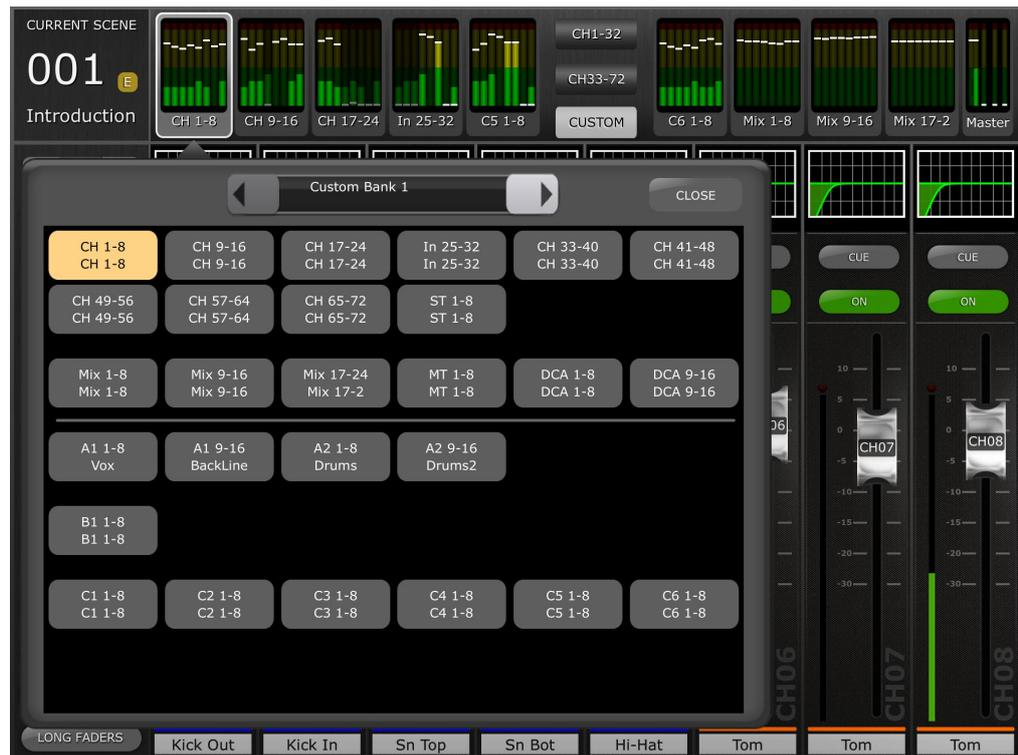
Die Navigationsschaltflächen Links und Rechts können verwendet werden, um zu anderen Meter-Blöcken zu navigieren, ohne das Zuordnungsfenster zu verlassen. Um das Zuordnungsfenster zu verlassen, tippen Sie auf irgendeine Stelle außerhalb des Fensters oder tippen Sie auf das Schließfeld in der oberen rechten Ecke.
