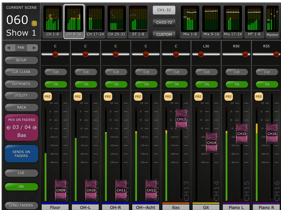
Die große Taste [MIX ON FADERS] zeigt die Nummer des momentan ausgewählten Mix- oder Matrix-Busses sowie dessen Namen an. Die Farbe dieser Taste stimmt mit den Farben im Pult der CL-Serie überein.
