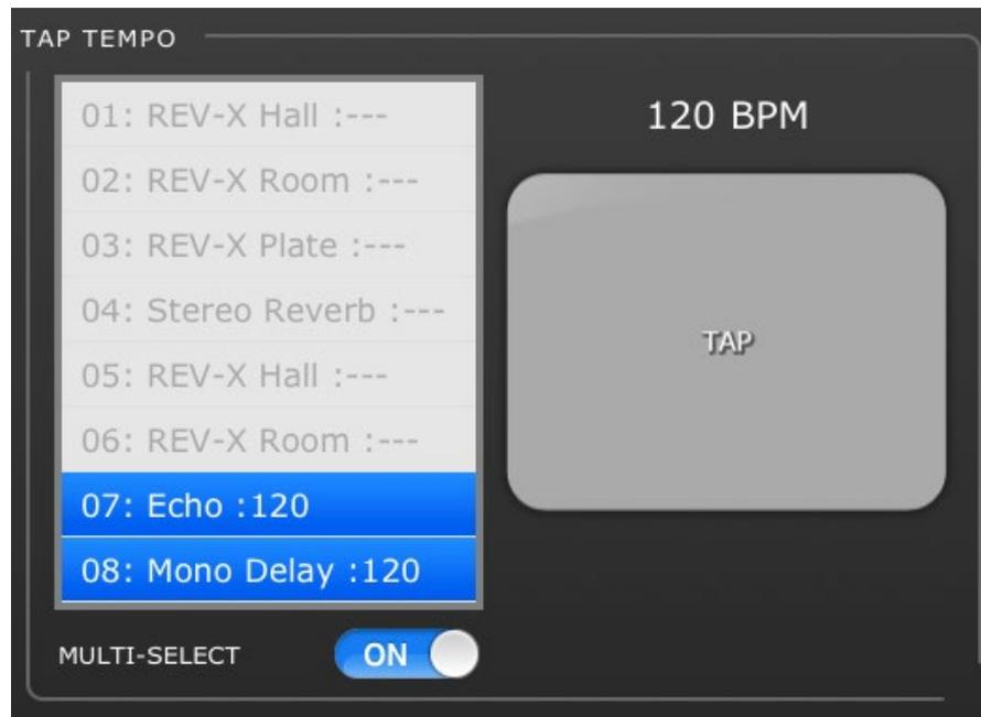
Wählen Sie den entsprechenden Effekt aus der Liste der 8 Effekte an der linken Seite dieses Bereichs aus. Effekte ohne BPM-Parameter sind ausgegraut und lassen sich nicht auswählen.
