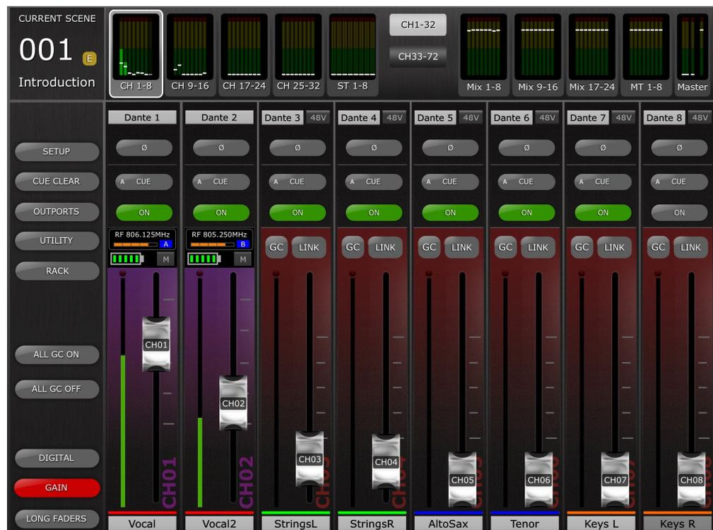
Der Fader steuert die Ausgangsverstärkung des Empfangskanals (RX). Über dem Schieberegler wird der aktuelle Batterieladezustand des
