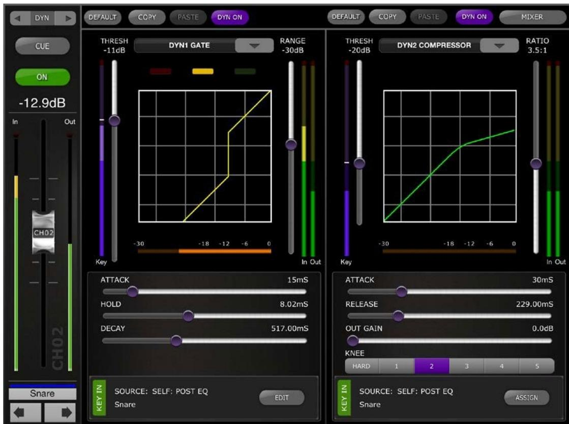
Die linke Seite dieses Bildschirms (Channel Strip) ist identisch mit dem Bildschirm zur EQ-Bearbeitung, mit Kanalfader, On-Schaltfläche, Cue-Schaltfläche, Ein- und Ausgangspegelanzeigen, Kanalnamen, Farb- und Navigationsschaltflächen.
