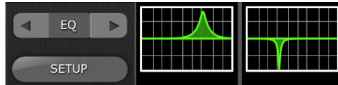
Mit den Tasten links der Miniaturansicht können Sie durch Antippen der linken und rechten Cursortasten zwischen EQ, PAN, 5.1 und Dynamik-Modus umschalten.
