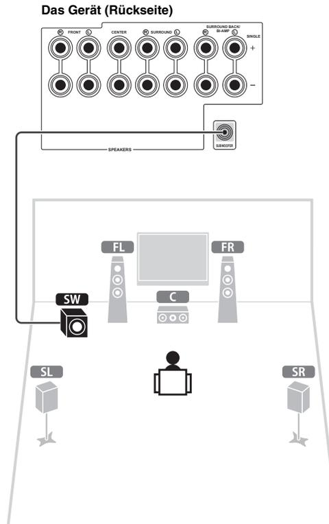
Verwenden Sie ein Mono-Cinchkabel zum Anschließen des Subwoofers.
