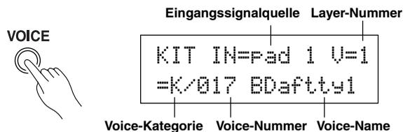
Bewegen Sie den blinkenden Cursor mit den Tasten [SEL◀] und [SEL▶] auf das Feld für die Eingangssignalquelle, und wählen Sie dann mit den Tasten [VALUE-] und [VALUE+] das "Pad 2". Das bedeutet: Sie wählen den Pad-Eingang für die Snare aus, die an der Trigger-Eingangsbuchse 2 SNARE angeschlossen ist.
