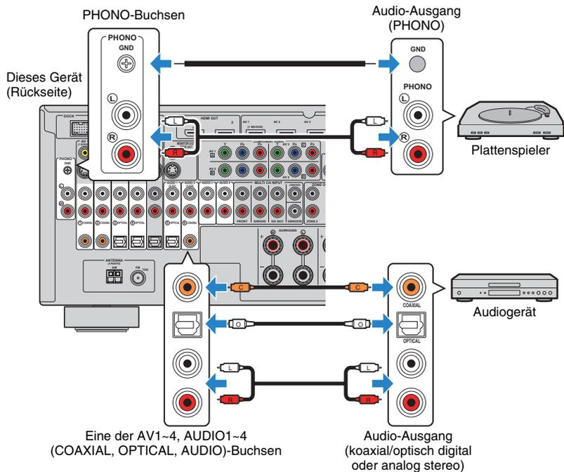
Wenn Sie die Eingangsquelle durch Drücken von AV1~4, AUDIO1~4 oder PHONO auswählen, werden die am Audiogerät abgespielten Audiosignale von diesem Gerät ausgegeben.
