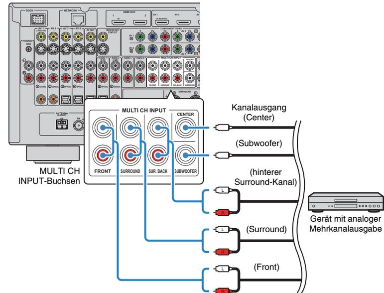
Wenn Sie die Eingangsquelle „MULTI CH“ durch Drücken von MULTI auswählen, werden die am Gerät abgespielten Audiosignale von diesem Gerät ausgegeben.
