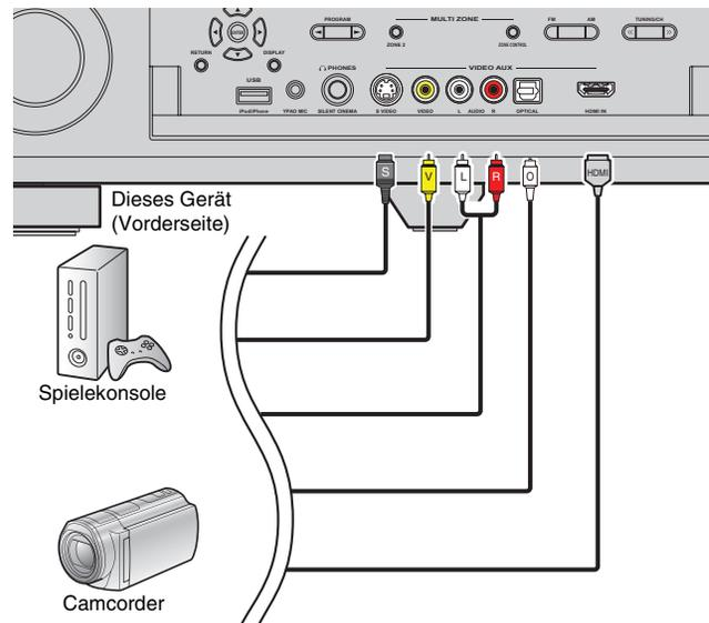
Wenn Sie die Eingangsquelle „V-AUX“ durch Drücken von V-AUX auswählen, werden die am Gerät abgespielten Video-/Audiosignale von diesem Gerät ausgegeben.
