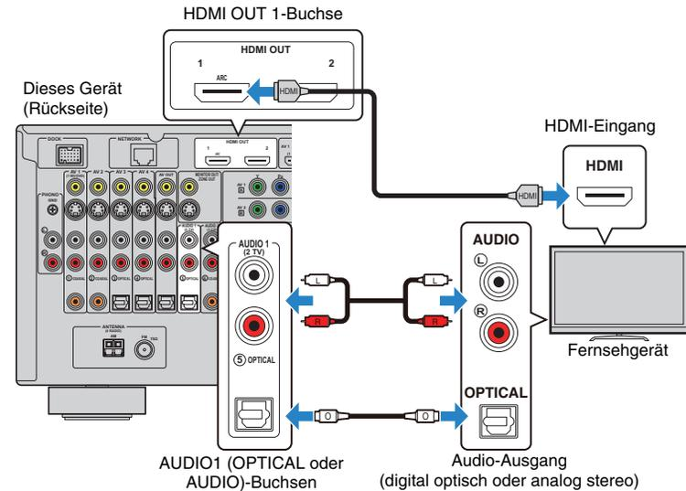
Wenn Sie mit der Taste AUDIO1 oder SCENE(TV) an diesem Gerät die Eingangsquelle an diesem Gerät auf „AUDIO1“ umschalten, wird der Fernsehton an diesem Gerät ausgegeben.
