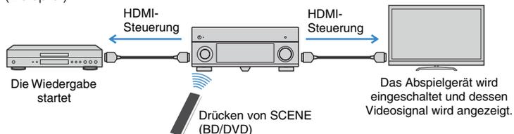
Um die HDMI-Steuerung zu verwenden, müssen Sie nach Anschluss des Fernsehgerätes und der Abspielgeräte die folgende Einrichtung der HDMI-Steuerungskopplung vornehmen.
