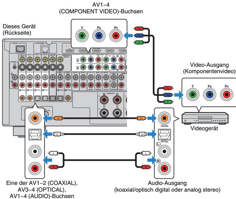
Wenn Sie die Eingangsquelle durch Drücken von AV1~4 auswählen, werden die am Videogerät abgespielten Video-/Audiosignale von diesem Gerät ausgegeben.
