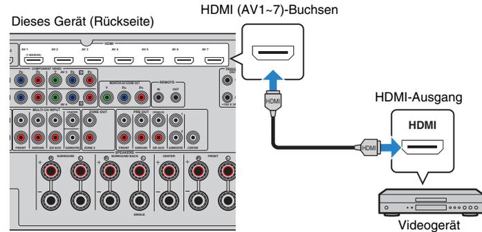
Wenn Sie die Eingangsquelle durch Drücken von AV1~7 auswählen, werden die am Videogerät abgespielten Video-/Audiosignale von diesem Gerät ausgegeben.
