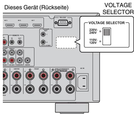
Nachdem alle Verbindungen hergestellt wurden, schließen Sie das mitgelieferte Netzkabel an diesem Gerät sowie an einer Netzsteckdose an.
