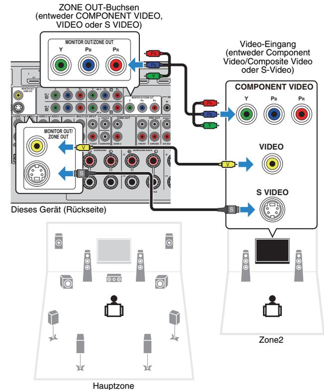
Um die ZONE OUT-Buchsen dem Videomonitor in Zone 2 zuzuweisen, stellen Sie „Monitorausgang Zuordnung“ (S. 107) im „Setup“-Menü auf „Zone2“.
