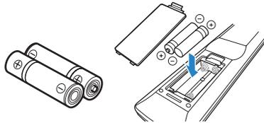
Setzen Sie die Batterien in der richtigen Ausrichtung (+/-) in die Fernbedienung ein.
