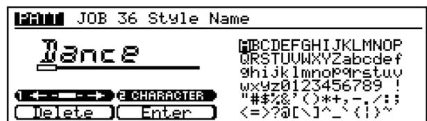
Questo job viene usato per impostare o cambiare il nome di uno stile. La lunghezza massima del nome é di 8 caratteri. Usate le manopole Display 1 e 2 per selezionare una locazione di carattere ed un carattere e premete il pulsante funzione F2 (Enter) per inserire il carattere specificato alla locazione selezionata. Il pulsante funzione F1 (Delete) può essere usato per selezionare una locazione di carattere e cancellare il carattere a quella locazione.
