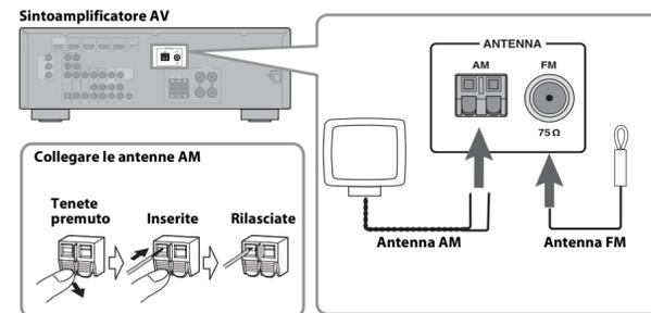
Collegate l'antenna AM (D) e l'antenna FM (E) al sintoamplificatore AV come mostra la figura. Per maggiori informazioni sul collegamento delle antenne, consultate i manuali dell'utente.
