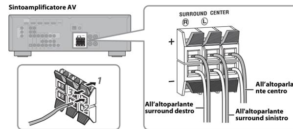
Collegate i cavi dell'altoparlante centrale (H) e dell'altoparlante surround (G) al sintoamplificatore AV. Assicuratevi di collegare gli altoparlanti con la polarità corretta - i terminali positivi (+) ai terminali positivi (+) e i terminali negativi (-) ai terminali negativi (-).
