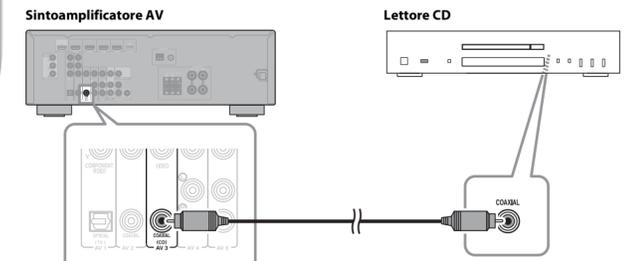
Utilizzate un cavo coassiale digitale (non fornito in dotazione) per collegare il lettore CD al connettore AV 3 COAXIAL(CD) del sintoamplificatore AV come mostra la figura.
