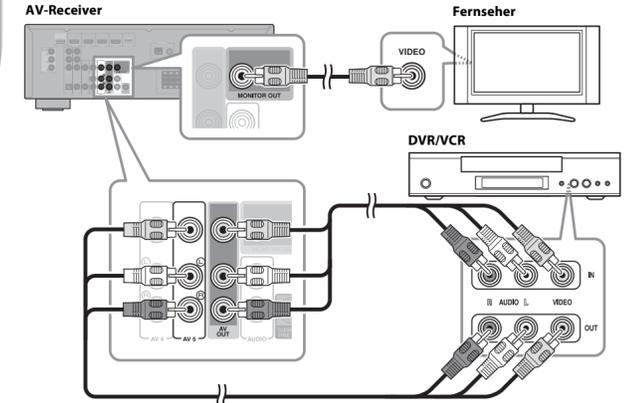
Schließen Sie die MONITOR OUT-Buchse des AV-Receivers über ein Video-Cinchkabel (nicht mitgeliefert) wie abgebildet am Composite-Eingang Ihres Fernsehers an.
