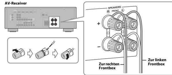
Schließen Sie die Kabel der Front-Lautsprecher (G) am AV-Receiver an. Vergewissern Sie sich, dass Sie die Boxen mit richtiger Polarität anschließen – Positive (+) Klemmen an positive (+) Klemmen und negative (-) Klemmen an (-) Klemmen.
