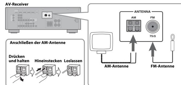
Schließen Sie die AM-Antenne (D) und die FM-Antenne (E) wie abgebildet am AV-Receiver an. Genauere Hinweise zum Anschließen der Antennen finden Sie in den betreffenden Bedienungsanleitungen.
