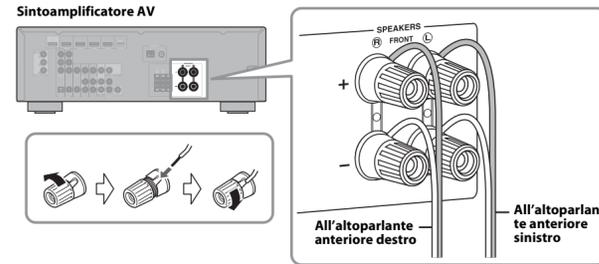
Collegate i cavi degli altoparlanti anteriori (G) al sintoamplificatore AV. Assicuratevi di collegare gli altoparlanti con la polarità corretta - i terminali positivi (+) ai terminali positivi (+) e i terminali negativi (-) ai terminali negativi (-).
