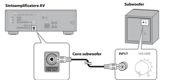
Utilizzate il cavo del subwoofer fornito in dotazione (J) per collegare il connettore INPUT del subwoofer al connettore SUBWOOFER PRE OUT del sintoamplificatore AV.
