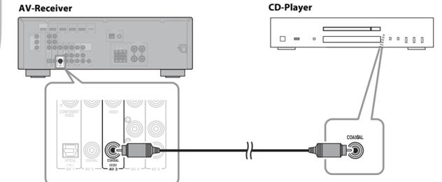
Verwenden Sie ein koaxiales Digitalkabel (nicht mitgeliefert), um Ihren CD-Player wie abgebildet mit der Buchse AV 3 COAXIAL(CD) des AV-Receivers zu verbinden.
