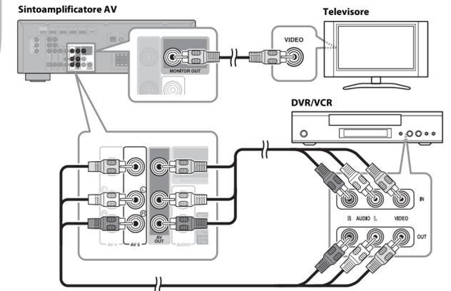
Utilizzate un cavo video a pin (non fornito in dotazione) per collegare il connettore MONITOR OUT del sintoamplificatore AV a un ingresso video composto del televisore come mostra la figura.
