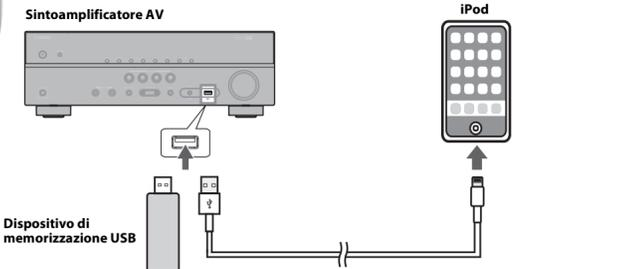
Collegare un dispositivo di memorizzazione USB o un cavo USB in dotazione con l'iPod al connettore USB del sintoamplificatore AV (sul pannello anteriore) come mostra la figura.
