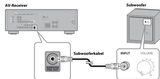
Verbinden Sie die INPUT-Buchse des Subwoofers mit Hilfe des beiliegenden Subwooferkabels (J) mit der Buchse SUBWOOFER PRE OUT am AV-Receiver.
