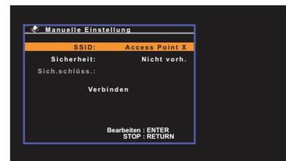
**1 Verwenden Sie die Cursortasten (Δ/▽) zur Auswahl von „SSID“, und drücken Sie ENTER.**
