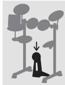
2. Assemblare la base del supporto come mostrato in basso quindi, partendo dal lato della base, montare i galletti, le rondelle elastiche e le rondelle piatte rimosse nel passo 1. per fissare la base in posizione.
