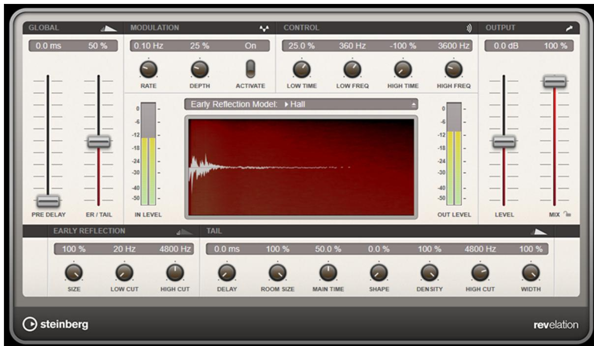
Le prime riflessioni sono responsabili dell'impressione spaziale nei primi millisecondi del riverbero. Per l'emulazione di diversi tipi di stanze è possibile scegliere tra vari pattern di prime riflessioni e modificarne la dimensione. La coda del riverbero offre diversi parametri per il controllo della dimensione della stanza e del tempo del riverbero. Il tempo del riverbero può essere regolato attraverso 3 bande di frequenza, in maniera individuale.
