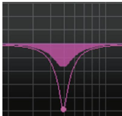
Se SIDECHAIN [LISTEN] è attivato, vengono visualizzate le caratteristiche del filtro side-chain.
