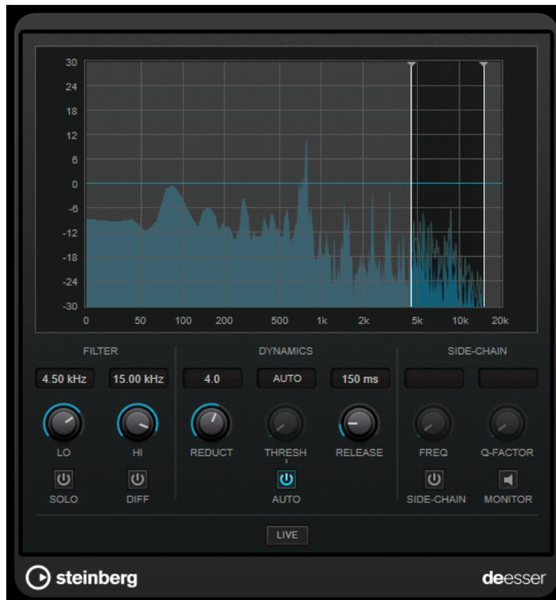
Può essere utilizzato ad esempio quando un posizionamento microfonico molto ravvicinato e l'equalizzazione portano a situazioni di suono complessivamente buono, ma con problemi con le sibilanti. Quando si registra una voce, generalmente il DeEsser si trova nella catena del segnale dopo il pre-amplificatore microfonico e prima di un compressore/limiter. Ciò consente di evitare che il compressore/limiter vada a limitare dove non necessario le dinamiche del segnale a livello complessivo.
