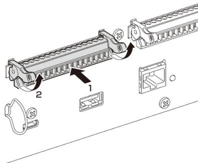
2. **Per rimuovere un connettore Euroblock, abbassare i blocchi destro e sinistro ed estrarre il connettore.**
