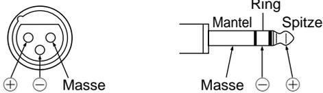
**Achtung:** Es kann nur jeweils eine der beiden Buchsen (Hi-Z oder Lo-Z) eines Kanals verwendet werden. Verwenden Sie immer die Buchse, die der angebotenen Signalquelle entspricht. Die Phantomspeisung wird entweder an alle Kanäle (1~8) gemeinsam oder überhaupt nicht angelegt. Daher müssen Signalquellen, die keiner Phantomspeisung bedürfen, an die Hi-Z- oder LINE-Buchsen angeschlossen werden – zumindest, wenn Sie den PHANTOM +48 V-Taster ("Frontseite" ②③) gedrückt haben.
