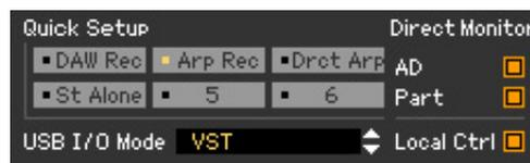
Von den im Quick Setup enthaltenen Parametern können Sie den Status von „USB I/O Mode“, „Direct Monitor“ und „Local Ctrl“ an den Anzeigen ablesen. Durch Klicken auf diese Anzeigen können Sie diese Parameter auch bearbeiten.
