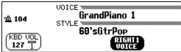
Bevor Sie die Einstellungen einer Funktion ändern können, müssen Sie sie auswählen. Im Haupt-Display ist die Funktion **RIGHT1 VOICE** hervorgehoben, was anzeigt, daß diese Funktion ausgewählt ist.
