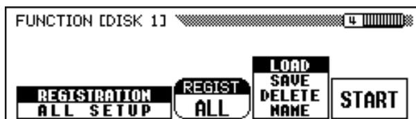
Wenn Sie Registrierungsdaten speichern, wird mit der **REGIST**-Einstellung angegeben, auf welchem Speicherplatz auf der Diskette gespeichert wird. Wenn Sie Daten laden, wird mit der **REGIST**-Einstellung angegeben, wie die gespeicherten Daten geladen werden, siehe weiter unten:
