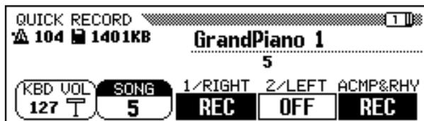
Wenn ein Part auf REC (record enable) eingestellt wird, erfolgt die Einstellung der Synchronized Start-Funktion auf Stand-by, und die Aufnahme startet automatisch mit Spielen auf dem Keyboard.
