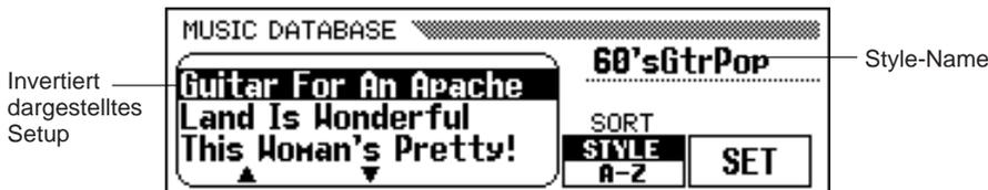
Die MUSIC DATABASE-Display enthält eine Liste mit „Panel Setups“ (Einstellungen aller Elemente auf dem Bedienfeld), die entweder nach Style oder nach Namen sortiert werden können. Der Style-Name, der vom invertiert dargestellten Setup verwendet wird, wird auch in der oberen rechten Ecke des Displays angezeigt.
