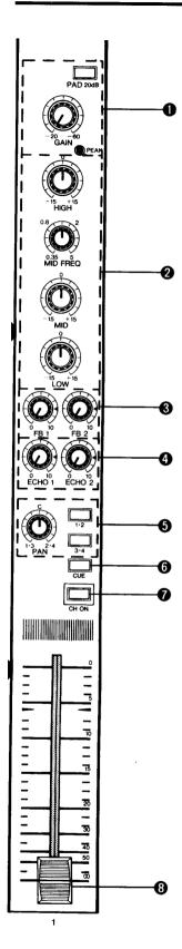
Commande d'atténuation (PAD), commande GAIN et Indicateur de crête Ces commandes permettent de régler la sensibilité d'entrée de la table de mixage sur une plage très étendue. La commande PAD permet d'introduire une atténuation de 20 dB avant l'étage préamplificateur, alors que la commande GAIN règle d'une manière continue la sensibilité de l'étage préamplificateur entre –20 et –60 dB.
