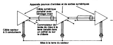
La solution la plus efficaces aux problèmes de mise à la terre et aux problèmes de bruits RFI, EMI et secteur, d'un système portable est peut être de mettre au point un système de mise à la terre polyvalant. L'utilisation de commutateurs de levée de mise à la terre et d'adaptateurs, avec un système de distribution du courant secteur, permet de tester diverses techniques de mise à la terre rapidement et facilement lorsqu'un problème se pose.
