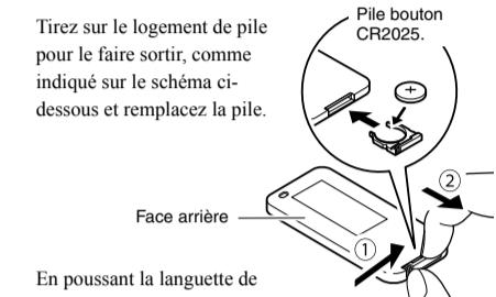
Tirez sur le logement de pile pour le faire sortir, comme indiqué sur le schéma ci-dessous et remplacez la pile.
