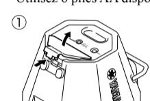
Pour retirer le couvercle des piles, poussez la languette en soulevant le couvercle vers le haut.
