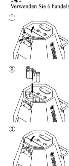
Um den Batteriedeckel zu entfernen, drücken Sie die Lasche und heben Sie den Deckel nach oben.
