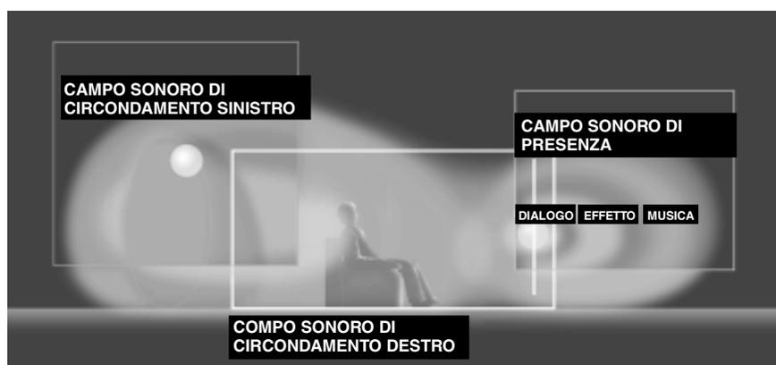
Oltre al DSP questa unità è fornita di vari decodificatori di precisione; decodificatore Dolby Pro Logic/Pro Logic II/ DTS Neo: 6 per fonti a 2 canali, decodificatore Dolby Digital/DTS per fonti multicanale e decodificatore Dolby Digital Matrix 6.1 o DTS ES per un canale posteriore centrale. E' possibile selezionare il programma CINEMA-DSP per ottimizzare questi decodificatori e la struttura del suono DSP a seconda della fonte in ingresso.
