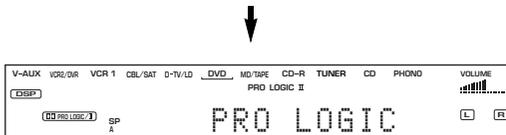
**3** Premere ripetutamente il pulsante numerico 12 per selezionare il decodificatore: PRO LOGIC, PRO LOGIC II o Neo: 6.
