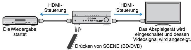
Um die HDMI-Steuerung zu verwenden, müssen Sie nach Anschluss des Fernsehers und der Abspielgeräte die folgende Einrichtung der HDMI-Steuerungskopplung vornehmen.
