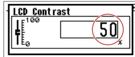
1. Numerische Werte können durch Drehen des Datenrades geändert werden. Das Drehen des Datenrades erzeugt eine sofortige und proportionale Änderung des gewählten Wertes.
