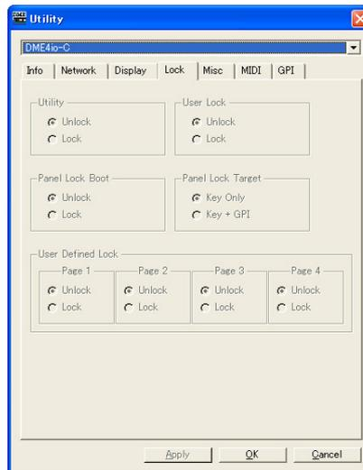
Zeigt die Panel-Lock-Parameter zum Sperren des DME64N/24N- und SP2060-Bedienfelds an bzw. ermöglicht deren Bearbeitung.
