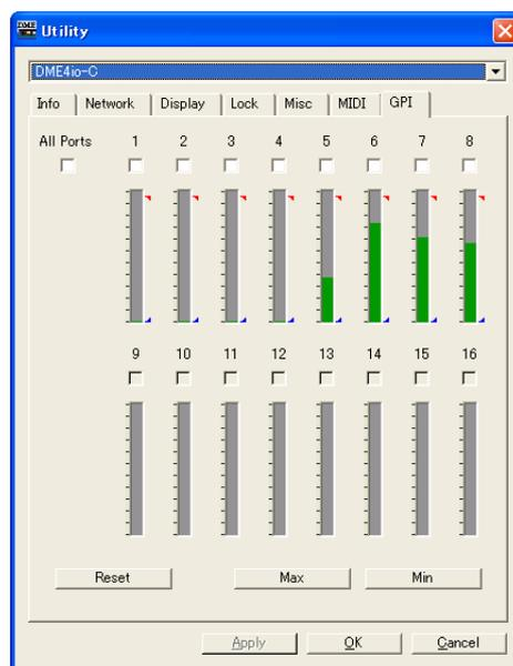
Kalibriert den Messbereich der Eingangsspannung für den GPI-Anschluss eines DME-Geräts.
