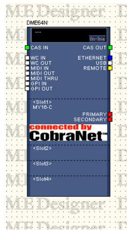
DME-Block mit eingefügter CobraNet-Karte
