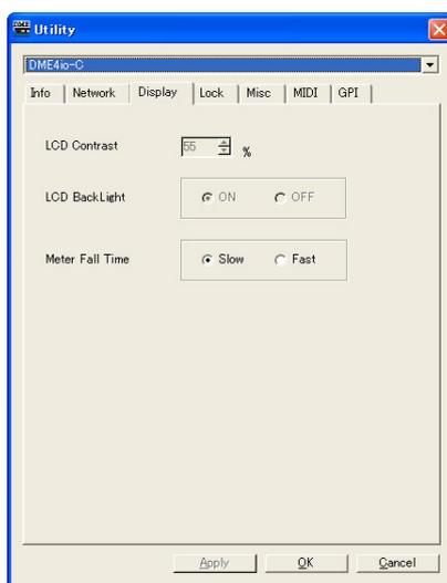
Zeigt die DME64N/24N-Displayanzeige an und ermöglicht deren Bearbeitung.
