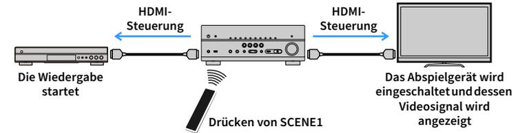
Um die HDMI-Steuerung zu verwenden, müssen Sie nach Anschluss des Fernsehers und der Abspielgeräte die folgende Einrichtung der HDMI-Steuerungskopplung vornehmen. Einzelheiten zu Einstellungen und zur Bedienung Ihres Fernsehers entnehmen Sie bitte dessen Bedienungsanleitung.
