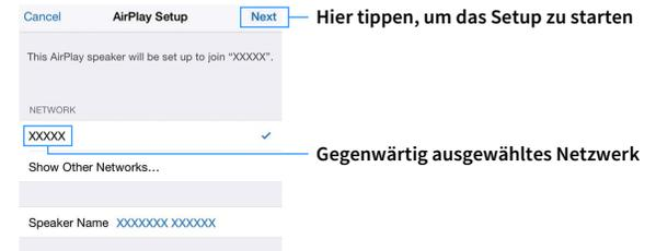
Nach Abschluss der Freigabe wird das Gerät automatisch mit dem ausgewählten Netzwerk (Access Point) verbunden.
