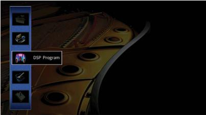
**3** Verwenden Sie die Cursortasten ( $\triangleleft/\triangleright$ ) zur Auswahl eines zu konfigurierenden Klangprogramms, und drücken Sie die Cursortaste ( $\triangle$ ).
