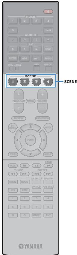
Die SCENE-Funktion erlaubt es Ihnen, die zugewiesene Eingangsquelle (einschließlich eines eventuell zugeordneten Radiosenders oder Inhalts) mit Klangprogramm und Compressed Music Enhancer ein/aus auf Tastendruck auszuwählen.
