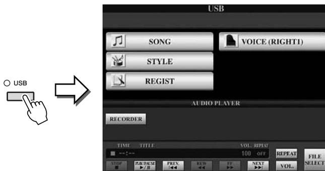
1-2 Drücken Sie die Taste [8 ▲▼] (FILE SELECT), um die auf dem angeschlossenen USB-Speichergerät gespeicherten Song-Daten (Audiodateien) anzuzeigen.
