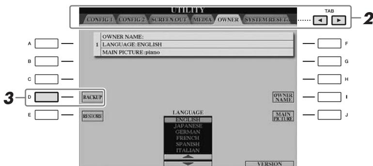
**3 Drücken Sie die Taste [D] (BACKUP), um die Daten auf dem USB-Speichergerät zu speichern.**
