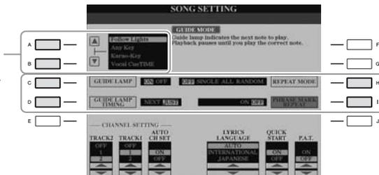
Die Tasten [C], [D], [H] und [I] werden verwendet, um den entsprechenden Parameter auszuwählen.
