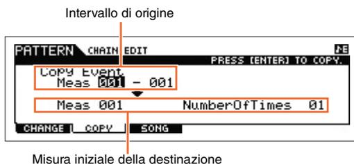
In questa schermata è possibile copiare gli eventi di sequenza di pattern da un intervallo specifico di misure (di origine) a una posizione di destinazione. Dopo aver specificato l'intervallo di origine in misure, la prima misura della posizione di destinazione e il parametro "NumberOfTimes" (numero di volte che i dati verranno copiati), premere il pulsante [ENTER] per eseguire l'operazione di copia.
