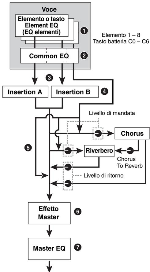
**1 Applicazione di Element EQ ai singoli elementi (per una voce normale) e ai singoli tasti (per un suono di batteria)**
