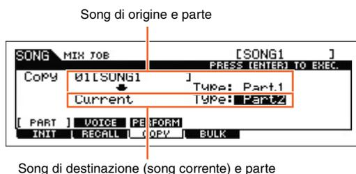
Da questa schermata è possibile copiare le impostazioni del parametro della parte da qualsiasi programma di messaggio che include quello editato in quel momento (ma non ancora memorizzato), per poi trasferirlo in una parte specifica del programma di messaggio che si sta modificando. Ciò è comodo se si desidera usare alcune impostazioni da un altro programma. La procedura è sostanzialmente la stessa della schermata [F3] COPY in Performance Job. Vedere a [pagina 70](#).
