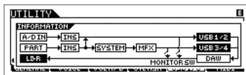
1StereoRec..... Il segnale audio proveniente dai jack A/D INPUT [L]/[R] e dal generatore di suoni viene trasmesso globalmente sui canali "USB 1/2" del jack USB TO [HOST]. Questa modalità è ideale se si utilizza un canale stereo (2 canali) come canali di uscita.
