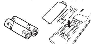
Setzen Sie die Batterien in der richtigen Ausrichtung (+/-) in die Fernbedienung ein.
