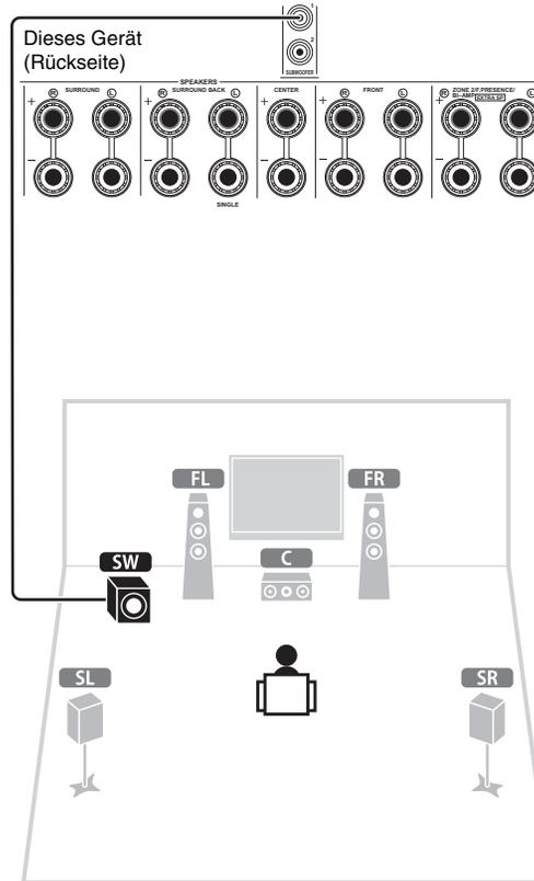
Verwenden Sie ein Audio-Cinchkabel zum Anschließen des Subwoofers (**SW**).
