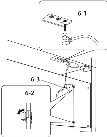
Bringen Sie das Pedalkabel sicher so an, dass der metallische Teil des Kabelsteckers nicht mehr sichtbar ist. Anderenfalls funktioniert das Pedal möglicherweise nicht richtig.
