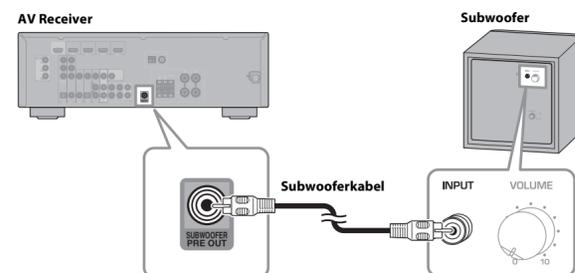
Verbinden Sie die INPUT-Buchse des Subwoofers mit Hilfe des beiliegenden Subwooferkabels (J) mit der Buchse SUBWOOFER PRE OUT am AV Receiver.
