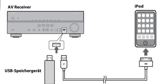
Verbinden Sie ein USB-Speichergerät oder das mit dem iPod gelieferte USB-Kabel wie abgebildet mit der USB-Buchse am AV Receiver (an der Frontblende).
