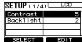
2. Ruotare il Controllo 1 per selezionare "Backlight", quindi ruotare il Controllo 2 per regolare la luminosità.
