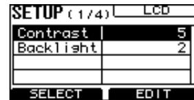
2. Ruotare il Controllo 1 per selezionare "Contrast", quindi ruotare il Controllo 2 per regolare la leggibilità del display.
