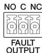
Il connettore [FAULT OUTPUT] (pagina 127) è costituito dai pin NO (Normally Open, normalmente aperto), C (Comune) e NC (Normally Closed, normalmente chiuso). Si tratta di un circuito con relè che funziona nel modo descritto di seguito.
