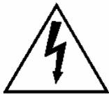
O símbolo do raio dentro do triângulo tem por objetivo alertar o usuário sobre a presença de voltagens perigosas não isoladas dentro do equipamento, que podem ter magnitude suficiente para constituir um risco de choque elétrico.
