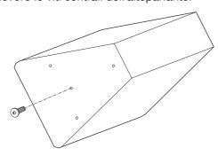
Se si utilizza il modello di altoparlante IF2115/AS(W), installare la staffa di fissaggio sull'altoparlante utilizzando le viti M10.
