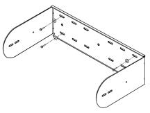
**5.** Posizionare l'altoparlante tra i bracci della staffa con le guarnizioni di isolamento acustico. Utilizzare ciascuna delle guarnizioni da 1/4" e 1/8" su un lato e una guarnizione da 1/4" sull'altro lato. Fissare l'altoparlante alla staffa utilizzando i supporti in dotazione mediante gli alloggiamenti desiderati all'interno dei fori filettati sulla struttura dell'altoparlante.
