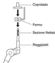
5. Quando il fermo è completamente a contatto con la superficie inferiore del copridado, come illustrato di seguito, stringere la vite del fermo utilizzando la chiave di accordatura.
