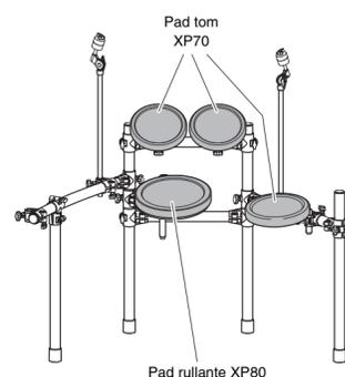
**2.** Inserire il pad rullante sul reggirullante del rack. Assicurarsi che l'elemento dell'asta sia completamente inserito nel foro di montaggio del pad rullante, quindi serrare il bullone di serraggio per fissare il pad.
