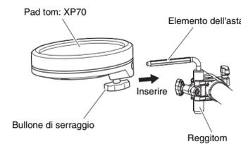
**3.** Allentare i bulloni da A a C, come illustrato di seguito, per regolare l'altezza e l'angolazione di ciascun pad tom. Una volta effettuato il corretto posizionamento, accertarsi di serrare di nuovo i bulloni in modo appropriato prima di procedere con l'operazione successiva.
