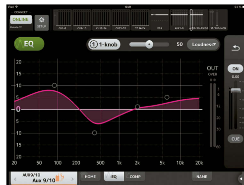
1-knob Modus Einstellung für den parametrischen EQ in den Ausgängen in der Einstellung „Loudness“ (Abb. 21)
