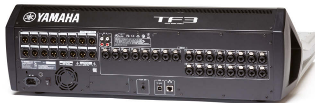
Anschlussfeld mit analogen Ein-/Ausgängen, Erweiterungsschacht und je einer Netzwerk- und USB-Buchse; Dante wird über eine NY64-Karte integriert
